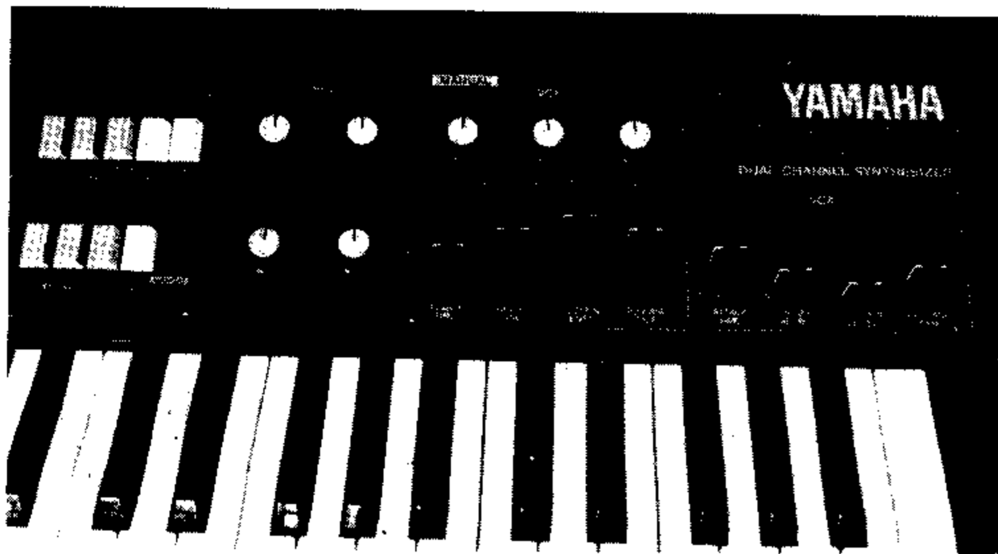
La partie «manuelle» du CS 15 D : le VCO, le VCF et le VCA.
