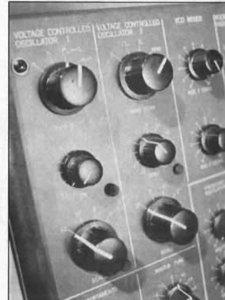
Les deux oscillateurs du MS20.
