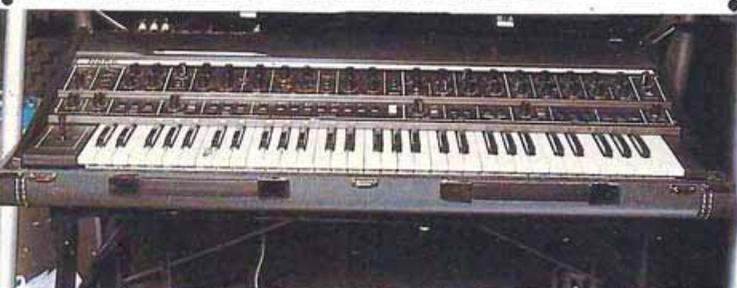
Le X 927 offre également à son utilisateur la possibilité de superposer plusieurs sons différents, sous l'impulsion d'un seul accord joué sur le clavier. Le 927 dispose d'un flanger intégré, son clavier est à cinq octaves, et divisible, il est associé à un manche à balai à quatre fonctions, et trois dispositifs peuvent être commandés par tension depuis l'extérieur. Détail intéressant pour les Roadies, il est construit dans sa propre boîte de transport...
