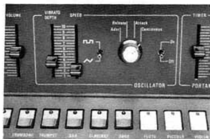
Dans le bas, quelques touches de sélection de jeux. Au-dessus, l'oscillateur de modulation, le commutateur rotatif permet quatre commandes originales tandis que l'interrupteur de droite coupe son fonctionnement à volonté.
