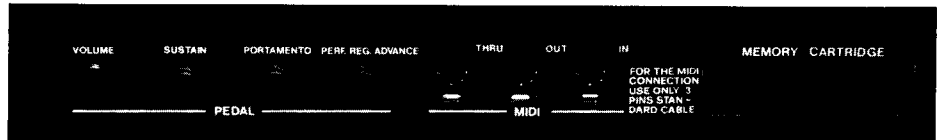
Rätselhafterweise befindet sich der Cartridge-Schacht auf der Rückseite neben den Pedal-Anschlüssen und den drei obligatorischen Midi-Buchsen.
