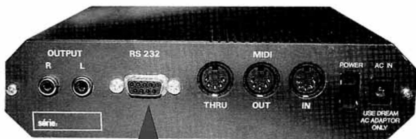
Sorties stéréo, interface MIDI exhaustive et interface RS 232 C : les trois "plus" du Dream XR.
