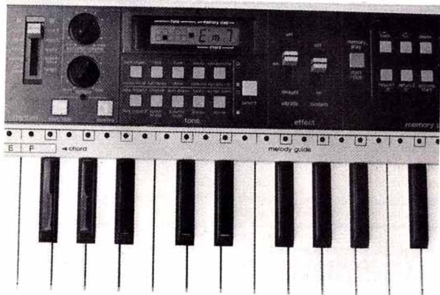
L'afficheur numérique à cristaux liquides, placé au-dessus des 10 presets, indique la preset sélectionnée, le nom de l'accord joué et le numéro de pas de programme.
